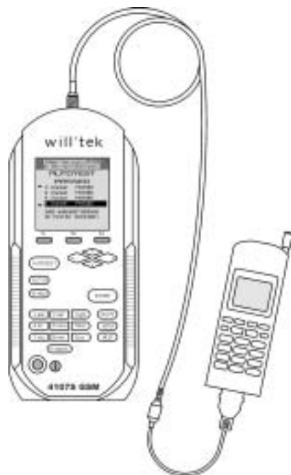
Le couplage par câble de l'appareil à tester est le meilleur choix pour des mesures de précision.
